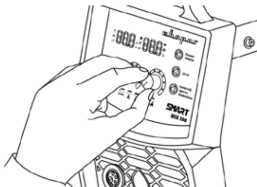
Рис. 9.19. Установка параметров сварки
