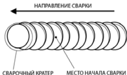
Рис. 12.4. Начало сварки при смене электрода.
