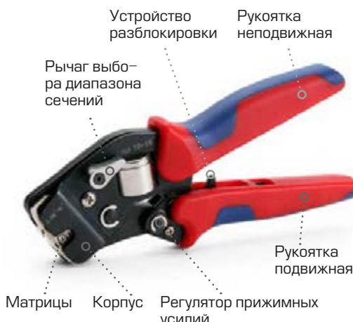
Прессы-клещи ПКВк-16т (КВТ) состоят из двухкомпонентной подвижной и неподвижной рукояток, матриц, расположенных в корпусе, регулятора прижимных усилий, храпового механизма и устройства разблокировки
