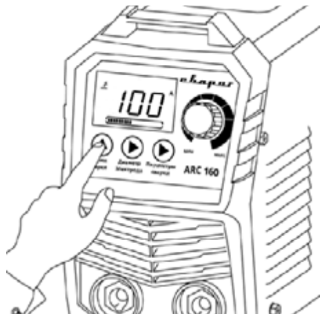
Рис. 11.2. Выбор способа сварки.
