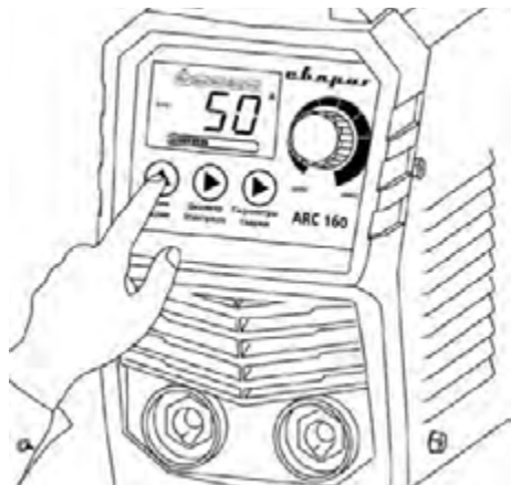
Рис. 9.5. Выбор способа сварки.
