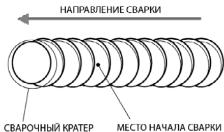
Рис. 10.4. Начало сварки при смене электрода.
