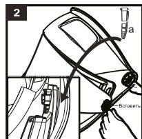
Для замены внутренней пластины вставьте палец в полукруглое отверстие и извлеките ее. Снимите с новой пластины защитную пленку. Поместите внутреннюю защитную пластину (B) так, чтобы она с двух сторон вошла в боковые пазы. Для этого ее нужно слегка изогнуть.
