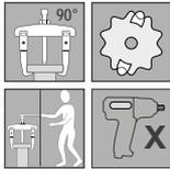
6.3 Не рекомендовано использовать электрические или пневматические гайковёрты, а также наращивать рычаг для увеличения крутящего момента. Для контроля усилия использовать динамометрический ключ.
