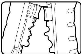
Стриппер WS-14 Вольтматсер имеет модуль для опрессовки, расположенный на полотне рукоятки:
