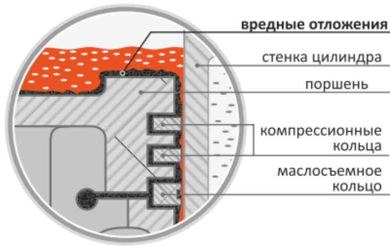
**Препарат для раскоксовывания двигателя ML202 эффективно и безопасно удаляет смолисто-коксовые отложения.** Благодаря этому восстанавливается компрессия и мощностные характеристики двигателя, снижается расход топлива и масла, а так же облегчается холодный запуск.
