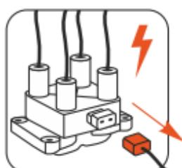
**3** Для бензинового двигателя - демонтировать свечи зажигания. Для дизельного - свечи накаливания или форсунки.
