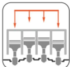
**5** С помощью шприца с удлинительной трубкой залейте равное количество жидкости в каждый цилиндр. Закройте технологические отверстия (например, вкрутите свечи зажигания на несколько витков) для образования «паровой бани» в камерах сгорания.
