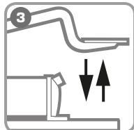
Нагнетайте давление педалью до завершения операции (при опрессовке - смыкание матриц, при резке - полное перерезание кабеля или до срабатывания АСД)
