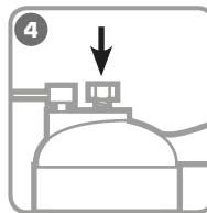
Закройте заднюю крышку/сливную пробку, удалите воздух из системы
