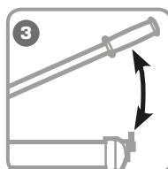
Произведите 3-5 качков рукояткой/педалью, плотно закрутите винт для сливания воздуха и проверьте помпу в работе. При необходимости повторите порядок действий.
