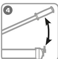
**Нагнетайте давление масла рукойкой/ педалью до завершения операции (при опрессовке - смыкание матриц, при резке - полное перерезание кабеля или до срабатывания АСД)**
