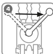
После завершения рабочего цикла поверните распределитель в крайнее правое положение. При этом давление в исполняющем инструменте полностью сбрасывается.
