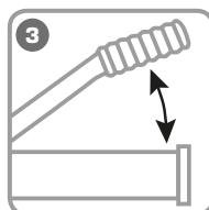
Произведите 3-5 качков рукояткой, плотно закрутите клапан для стравливания воздуха и проверьте помпу в работе. При необходимости повторите порядок действий.
