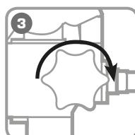
**Поверните винт сброса давления в положение «Закрыть»**
