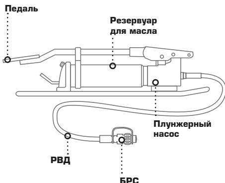
В помпе применён двухступенчатый плунжерный насос, имеющий две ступени нагнетания давления (кроме ПМР-7003). Первая ступень – низкого давления – позволяет обеспечивать подачу рабочей жидкости в достаточном объёме для ускорения движения поршня исполнительного устройства без нагрузки. Вторая ступень – высокого давления – способна создавать рабочее давление, необходимое для нормального функционирования исполнительного устройства. Переход с одной ступени на другую происходит автоматически.
