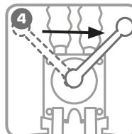
После завершения рабочего цикла поверните распределитель в крайнее правое положение. При этом давление в исполняющем инструменте №1 полностью сбрасывается.
