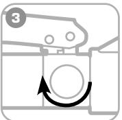
**Поверните винт сброса давления в положение «Закрыть»**
