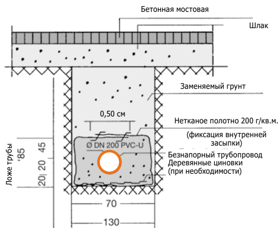
Рис. 7 Пример прокладки труб в мягком грунте
