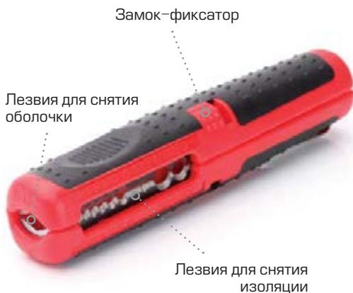
Ручной стриппер WS-09 представляет собой компактную двухкомпонентную рукоятку, состоящую из двух ответных частей с симметрично, расположеннымными, лезвиями для снятия изоляции с провода, зачистки коаксиального кабеля и V-образных лезвий для снятия оболочки с круглых кабелей, расположенного в торцевой части рукоятки
