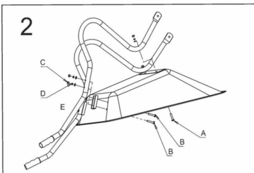
Важно обратить внимание на то, что закручивать гайки и болты креплений необходимо осторожно и равномерно, буквально по 1-2 оборота каждого за раз. Если закручивать по очереди и до упора, втулка может лопнуть.
