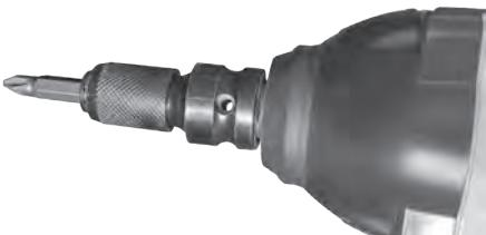
7.3 Установите гайку или головку болта в торцевую головку или наконечник биты в шлицы крепежного изделия. Начинайте работу.
