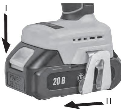
6.1.3 Отсоедините аккумулятор (14) от электроинструмента путем нажатия фиксатора (13).
