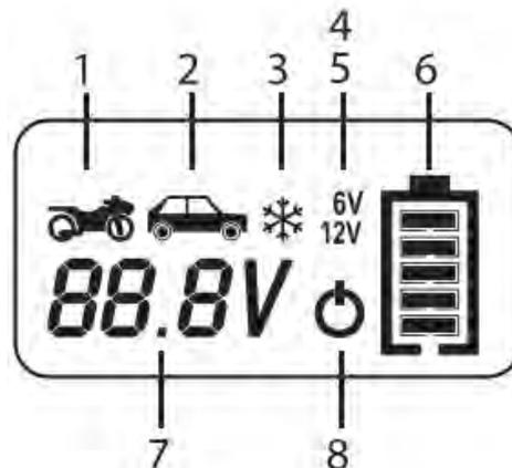
1. Индикация тока заряда 4А. Режим используется для зарядки аккумуляторов небольшой емкости, используемых в мотоциклах, квадроциклах, снегоходах, гидроциклах, садовых тракторах и автомобилях для гольфа.
