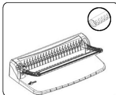
Установите пружинку на гребенку. Потяните за рычаг, чтобы открыть пружинку, зафиксируйте пружину рычагом регулятора пружины. Вставьте перфорированные листы на открытую пружинку, верните рычаг в исходное положение, извлеките переплетенный документ.
