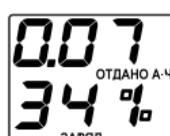
Процент заряда определяется на основании оценочного алгоритма и позволяет оценить время до полного заряда А.Б.
