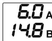
На экране отображается текущий ток и напряжение.
