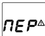
З.У. имеет электронную защиту от переполюсовки. При неправильном подключении З.У. отключается от аккумулятора, на экране замигают надпись “PER” и значок тревоги. После отсоединения клемм З.У. от аккумулятора работоспособность З.У. автоматически восстанавливается.
