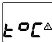
Для защиты силовой части от перегрева применена схема ограничения выходного тока. Эта схема автоматически уменьшает выходной ток при повышении температуры внутри корпуса выше нормы. На экране замигают надпись “ $t^{\circ}\text{C}$ ” и значок тревоги. После уменьшения внутренней температуры источник вернется к обычному функционированию.
