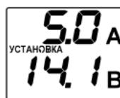
При изменении положения переключателя напряжения и/или ручки установки тока на экране отобразится надпись “УСТАНОВКА”, устанавливаемое значение будет мигать в течении нескольких секунд.
