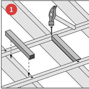
1 Сечение бруса обрешетки 40x60мм или 50x50мм (чем больше расстояние между стропилами, тем больше сечение бруса обрешетки). Выдерживайте шаг обрешетки, используя деревянный интервал.
