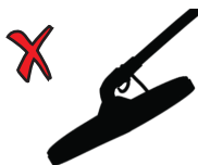
Неверный угол поисковой катушки к земле
