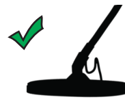
Правильный угол поисковой катушки к земле
