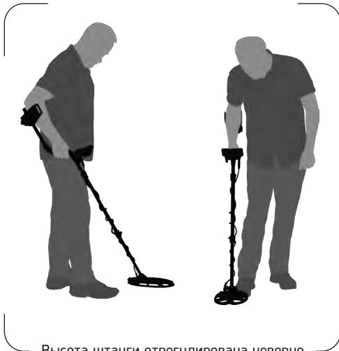
Высота штанги отрегулирована неверно
