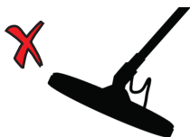
Неверный угол поисковой катушки к земле
