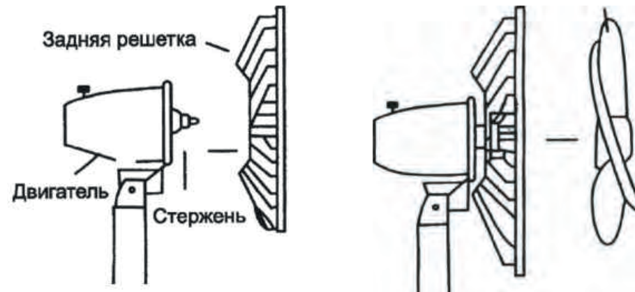
Наденьте лопасти на стержень двигателя. Лопасты
