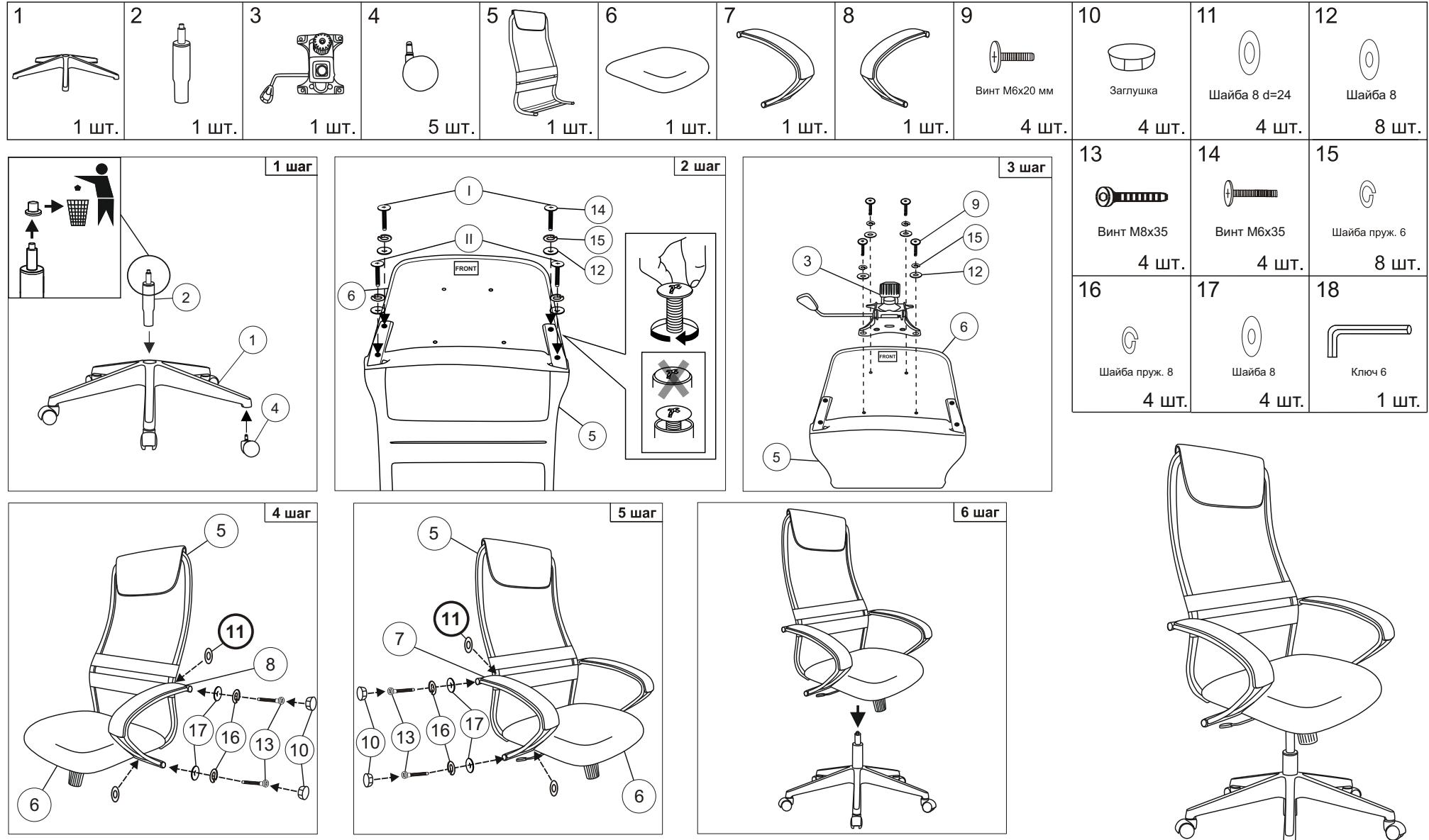
Примечание: Шаг 1. Снять защитный колпачок с газлифта, в случае его наличия. В шаге 2 сначала закрутить винты I, не затянув их до конца. Далее закрутить винты II до полной фиксации. После этого винты I закрутить до полной фиксации.
