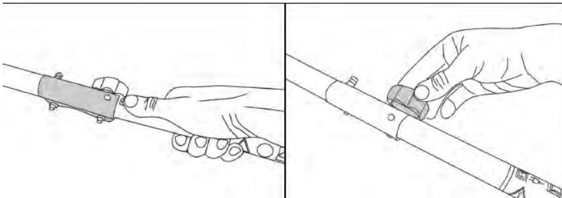
**Внимание!** Не работайте инструментом, если верхняя и нижняя части штанги плотно не зафиксированы.
