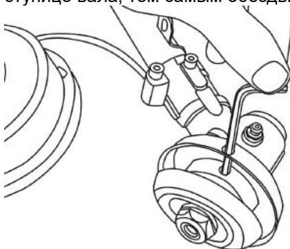
Удерживая отвертку или ключ, открутите гайку крепления со ступицы.
