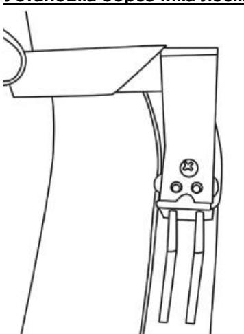
5. Установите на кожух обрезчик лески. Затяните болтами из комплекта.
