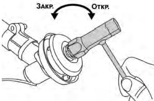
Для крепления катушки с леской снимите чашку с вала, оставив ступицу. Удерживая ключ или отвертку, закрутите катушку с леской против часовой стрелки до упора (левосторонняя резьба).
