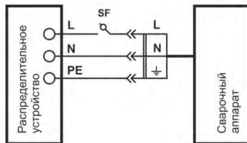
**Примечание:** символ  $\text{---} \parallel$  – обозначение провода заземления. Данный провод имеет желто-зеленую маркировку изоляции.
