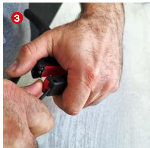
С помощью тонкой отвертки с плоским шлицом выдавите верхний ограничитель.
