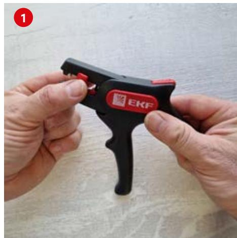
Извлеките ограничитель из нижней направляющей. Для этого переверните инструмент рукоятками вверх и с помощью тонкой отвертки с плоским шлицем выдавите нижний ограничитель.
