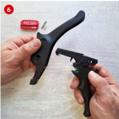
С помощью отвертки с крестовым шлицем открутите винт, фиксирующий верхнее лезвие. Произведите замену лезвия на новое. Заденьте винт.
