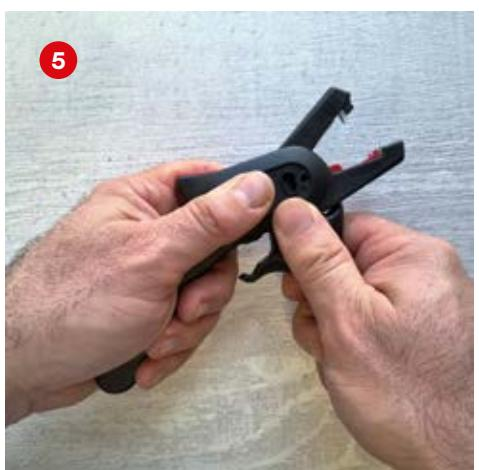
Зафиксируйте неподвижную рукоятку одной рукой. Второй возьмитесь за подвижную рукоятку, слегка покачайте ее взад-вперед и разведите рукоятки инструмента на максимальное расстояние. После этого потяните подвижную рукоятку «на себя» и извлеките ее из корпуса инструмента. Перед разборкой осмотрите положение стальной пружины кручения. Запомните ее положение. Это поможет Вам при сборке.
