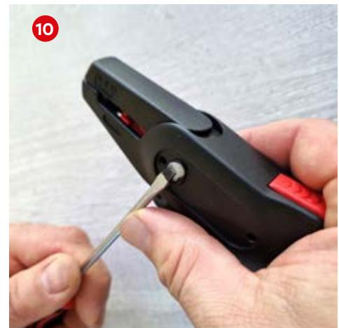
Заденьте ее положение с помощью двух пластиковых демпферов.
