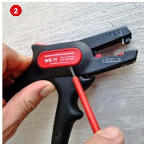
Снимите боковые декоративные заглушки. Заведите жало тонкой отвертки с плоским шлицем в специальные технологические углубления в заглушке и аккуратно отделите ее от корпуса инструмента. Не прикладывайте при этом чрезмерного усилия. Таким же образом отделите вторую заглушку с противоположной стороны инструмента.
