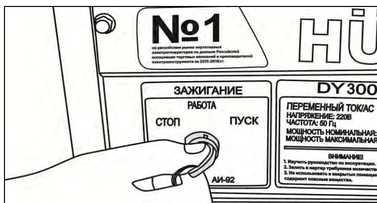
Рис. 17. Запуск двигателя электростартером
