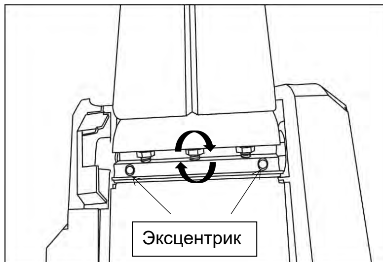
Рис.3. Замена режущего ножа
