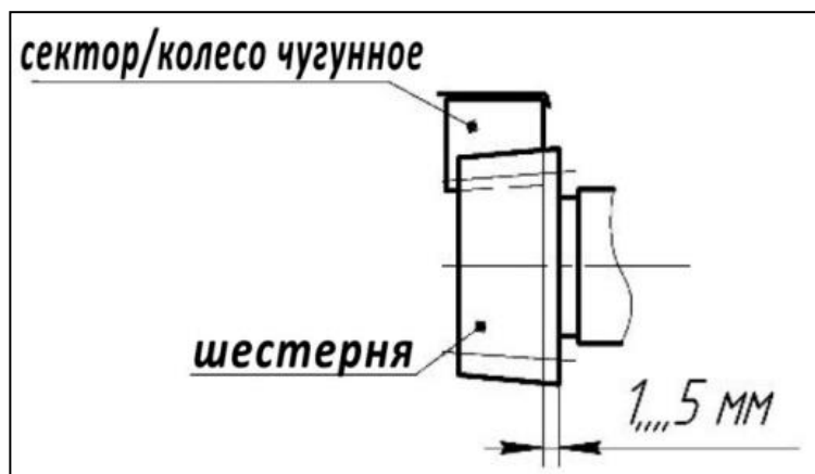
Рис. 7. Допустимый зазор
