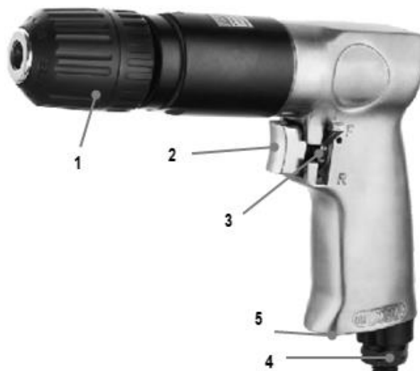
1 – Патрон зажимной; 2 – Кнопка включения; 3 – Переключатель направления вращения; 4 – Подключение воздуха; 5 – Выход воздуха
