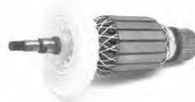
– внутренняя часть выполнена способом полностью автоматического накручивания нити, вокруг ротора добавлена сетка, препятствующая попаданию на эмалевые провода пыли, мелких камней и других инородных тел (эмалевый провод выполнен из медной проволоки, обладает устойчивостью к высоким температурам до 180°C), что увеличивает срок службы ротора. Содержание серебра в коммутаторе 8/10000, что делает поверхность коммутатора более гладкой, увеличивая срок эксплуатации.
