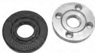
верхняя гайка-фланец никелированная, серебристого цвета, нижняя шайба упорная – черного цвета с шероховатой структурой, что повышает надежность фиксирования диска, одновременно увеличивает эффективность работы и снижает чувство вибрации в руках во время работы.
