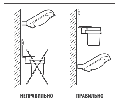
Рис 1. Схема установки фотореле
