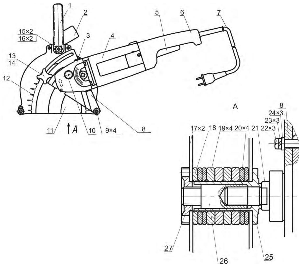
1 - ручка; 2 - патрубок; 3 - редуктор; 4 - электропривод; 5 - клавиша переключателя; 6 - ручка-накладка; 7 - шнур питания; 8 - рычаг; 9 - ролик; 10 - кнопка; 11 - корпус; 12 - шкала; 13 - винт; 14 - шайба; 15 - винт; 16 - шайба; 17 - отрезной круг; 18 - втулка; 19 - втулка; 20 - втулка; 21 - шпindelь; 22 - винт; 23 - шайба; 24 - шайба; 25 - втулка; 26 - ось; 27 - гайка.
