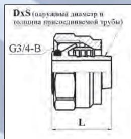
Соединители конусные являются импортозамещающей продукцией. Изделия предназначены для присоединения полимерных труб к трубопроводной арматуре в системах отопления и водоснабжения при температуре рабочей среды до 120°C и номинальном давлении до 1,0 МПа.
