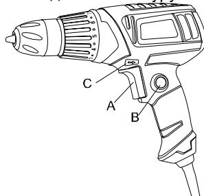
**2** Для запуска шуруповерта надавите на курковый выключатель. Выключатель чувствителен к силе нажатия. Максимальное нажатие соответствует максимальной скорости вращения двигателя шуруповерта.
