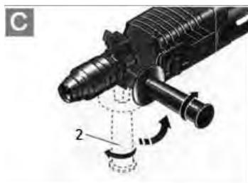
По соображениям техники безопасности эксплуатировать прибор допускается только с дополнительной рукояткой 2.
