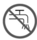
Согласно действующим предписаниям устройство запрещается подключать непосредственно к коммунальной хозяйственно-питьевой системе без системного разделителя в трубопроводе. Убедитесь, что подключение к домовой сети водопровода, к которому подсоединен моющий аппарат высокого давления, оснащено обратным клапаном в соответствии с EN 12729, тип ВА. Вода, прошедшая через системный разделитель, считается непригодной для питья.
