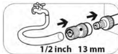
Длина шланга должна быть не менее 10 м для сглаживания возможных гидравлических ударов и не более 25 м. Ограничение по максимальной длине шланга связано с возможным падением давления воды в шланге и завоздушиванием системы.
