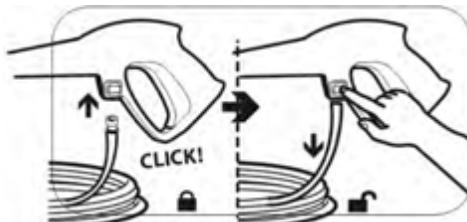
Ниппель высоконапорного шланга вставьте до щелчка в быстросъемное гнездо рукоятки моечного пистолета. Перед началом работы с мойкой убедитесь, что высоконапорный шланг полностью размотан и не имеет петель по всей длине. Следите, чтобы во время работы мойки высоконапорный шланг не образовывал петли. Это может оказаться на результатах работы при использовании мойки.
