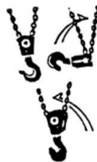
Рис. 6 Неправильное положение крюка.
