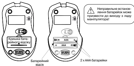
Мал. 4. Встановлення батареїок
