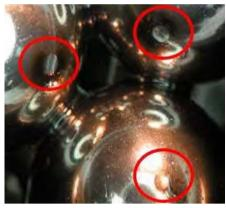
Диаметр пятна износа **Dи** характеризует противоизносные свойства смазки. Чем меньше его значение, тем лучше. Значение критической нагрузки **Pк** связано с максимальной нагрузкой, при которой узел трения может эксплуатироваться длительно.
