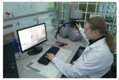
Определение предела прочности произведены на реометре Anton Paar Physica MCR 102.
