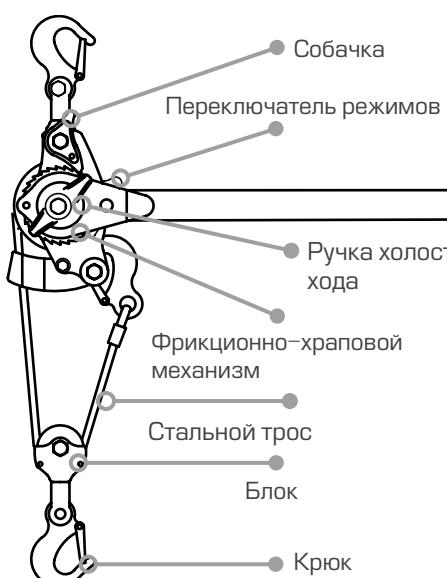
Лебедка состоит из фрикционно-храпового механизма для ступенчатого вращения барабана. Фрикционно-храповый механизм приводится в действие за счет возвратно-поступательных движений рукоятки, при этом на барабан наматывается стальной канат
