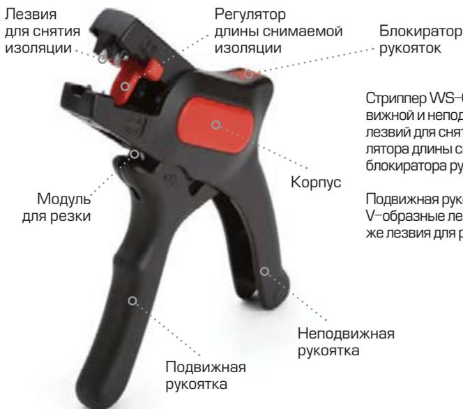
Стриппер WS-06 состоит из корпуса, подвижной и неподвижной рукояток, V-образных лезвий для снятия изоляции с провода, регулятора длины снимаемой изоляции, а так же блокиратора рукояток
