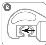
Установите ответную матрицу в посадочное отверстие в рабочей головке
