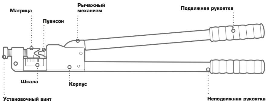
Пресс механический универсальный состоит из корпуса и рукояток. В рабочей зоне корпуса пресса установлены V-образная матрица и пуансон.
