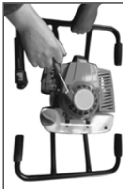
Рис. 9 Свободный ход шнура стартера
