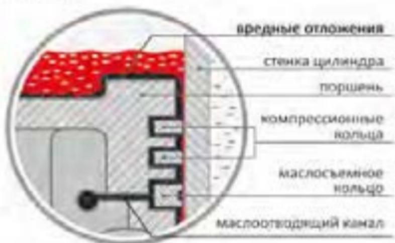
*Рекомендуется проводить расконсервацию двигателя каждые 20-25 тыс. км пробега при замене масла, или 10-15 тыс. км - при эксплуатации в тяжелых условиях: высокие нагрузки, сомнительное качество ГСМ, перегрев двигателя.*
