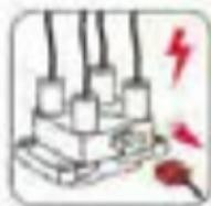
**3** Для бензинового двигателя – демонтируйте свечи зажигания. Для дизельного – свечи накаливания или форсунки.
